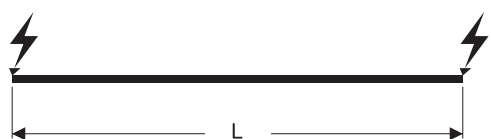
2 punti di alimentazione dai punti iniziali, L_t = L/4
