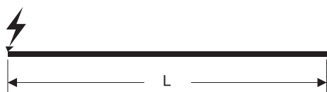
1 punto di alimentazione dall'inizio, L_t = L
