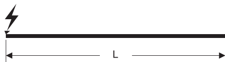
1 punto di alimentazione dall'inizio, L_t = L
