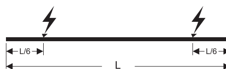
2 punti di alimentazione, L_t = L/6
