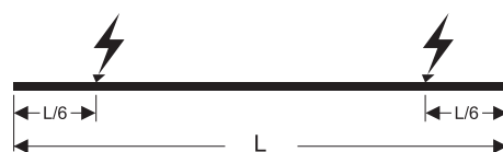
2 punti di alimentazione, L_t = L/6
