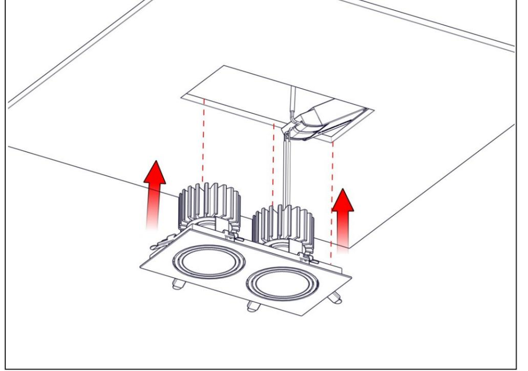
2) Enerji besleme bağlantısı driver kutusuna yapıldıktan sonra tavandaki montaj deliğinden geçirilerek serbest bir biçimde tavan boşluğuna bırakılır.
