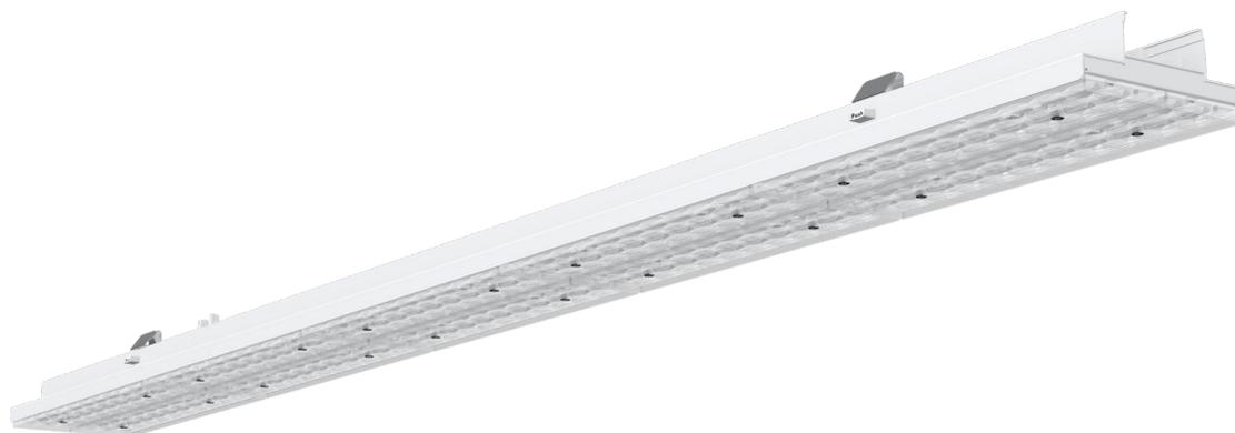
INFINO a fila doppia offre due opzioni di lunghezza (1433 mm e 1720 mm), 5 opzioni ottiche (30°/ 60°/ 90° / asimmetrica / asimmetrica doppia) 3 opzioni di flusso luminoso (16000 / 20000 / 27500 lumen). L'apparecchio può essere montato senza attrezzi.
